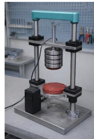
а) б) 1 – основа макету; 2 – напрямна для ударного молота; 3 – тестовий зразок; 4 – блок для датчику акселерометра; 5 – ударна площадка; 6 – ударний молот. Рисунок 1 – Принцип дії макету для ударного тестування зразків (а) та розроблений макет за цією схемою (б)
