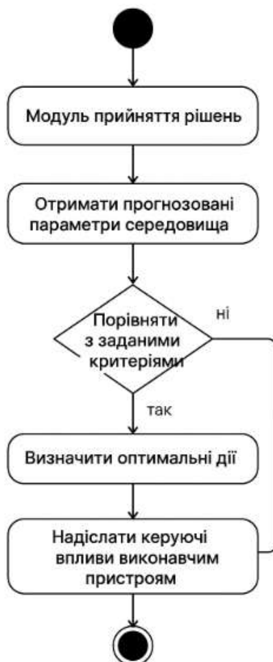
Рисунок 3.3 – Діаграма діяльності модуля прийняття рішень в інтелектуальній системі управління мікрокліматом
