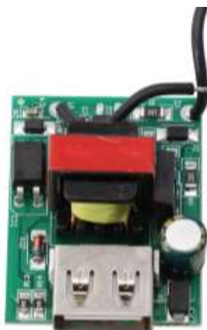
Рисунок 2.7 – Знижувач напруги USB-DC-DC-StepDown-5V-1A [23]
