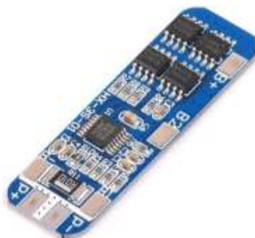
Рисунок 2.8 – Модуль контролю заряду акумулятора BMS 18650 3S 10A [25]
