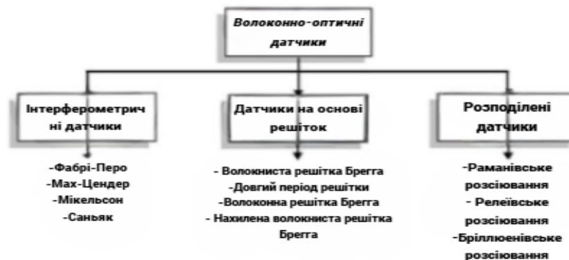
Рисунок 1.1 – Огляд основних принципів і типів волоконно-оптичних датчиків
