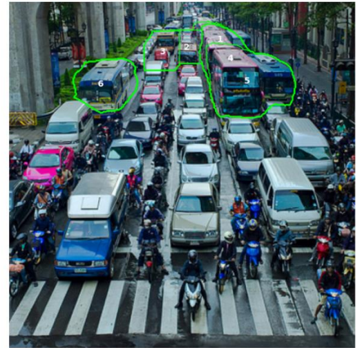
Рисунок Б.5 – Результат роботи InstanceCLIPSeg за запитом «a photo of a bus»
