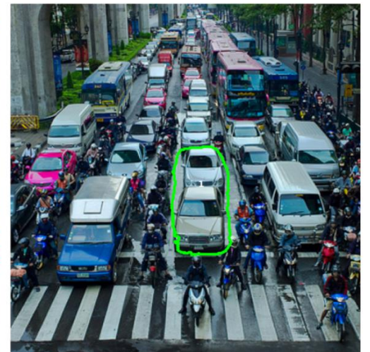
Рисунок Б.6 – Результат роботи InstanceCLIPSeg за запитом «a photo of a gray car in the middle»
