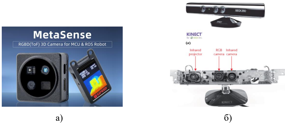
Рисунк 1.4 – Приклади не стерео-датчиків глибини: а) камера з часом прольоту (ToF); б) Microsoft Kinect (або аналогічні ІЧ-датчики)
