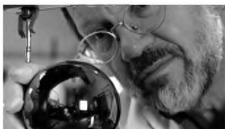
Сфера из кремния-28 с чистотой 99,9998. Foto: CSIRO Precision Optics Sphere of silicon-28 with a purity of 99,9998. Photo: CSIRO Precision Optics
