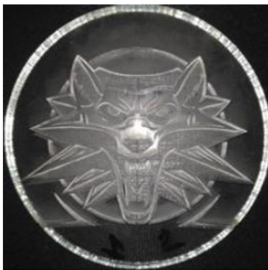
Рисунок 3.5 – Гравіювання оргскла, здійснене за заданими параметрами
