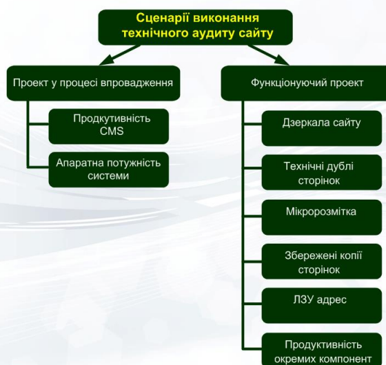
Рисунок 2 - Типовий склад кожного з базових сценаріїв реалізації технічного аудиту веб-вузла
