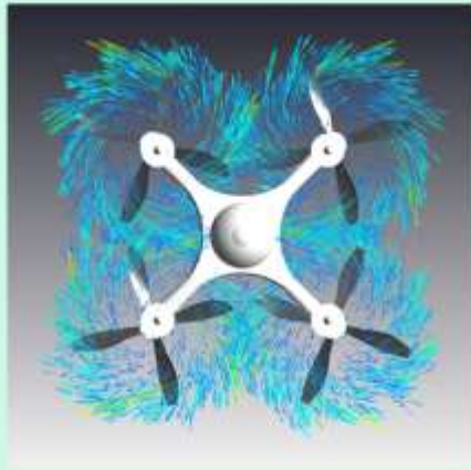
Рисунок А.8 – Тривимірна візуалізація векторів та швидкостей повітряних потоків, що набігають з гвинтів БПЛА
