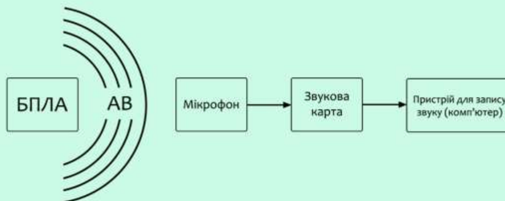
Рисунок А.14 – Структурна схема експериментальної установки
