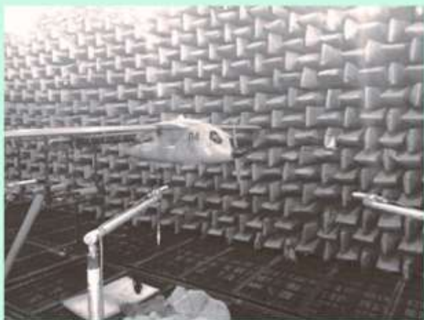
Рисунок А.6 – Зображення вимірювання АВ БПЛА у заглушеній камері
