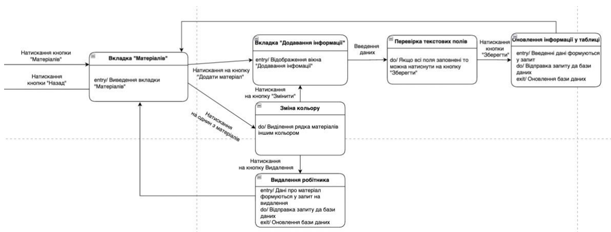
Рисунок 2.6 – Діаграма станів для розроблюваного програмного забезпечення для вкладки матеріалів
