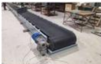
Рисунок 1 – Стрічковий конвеєр з автоматизованою системою управління.
