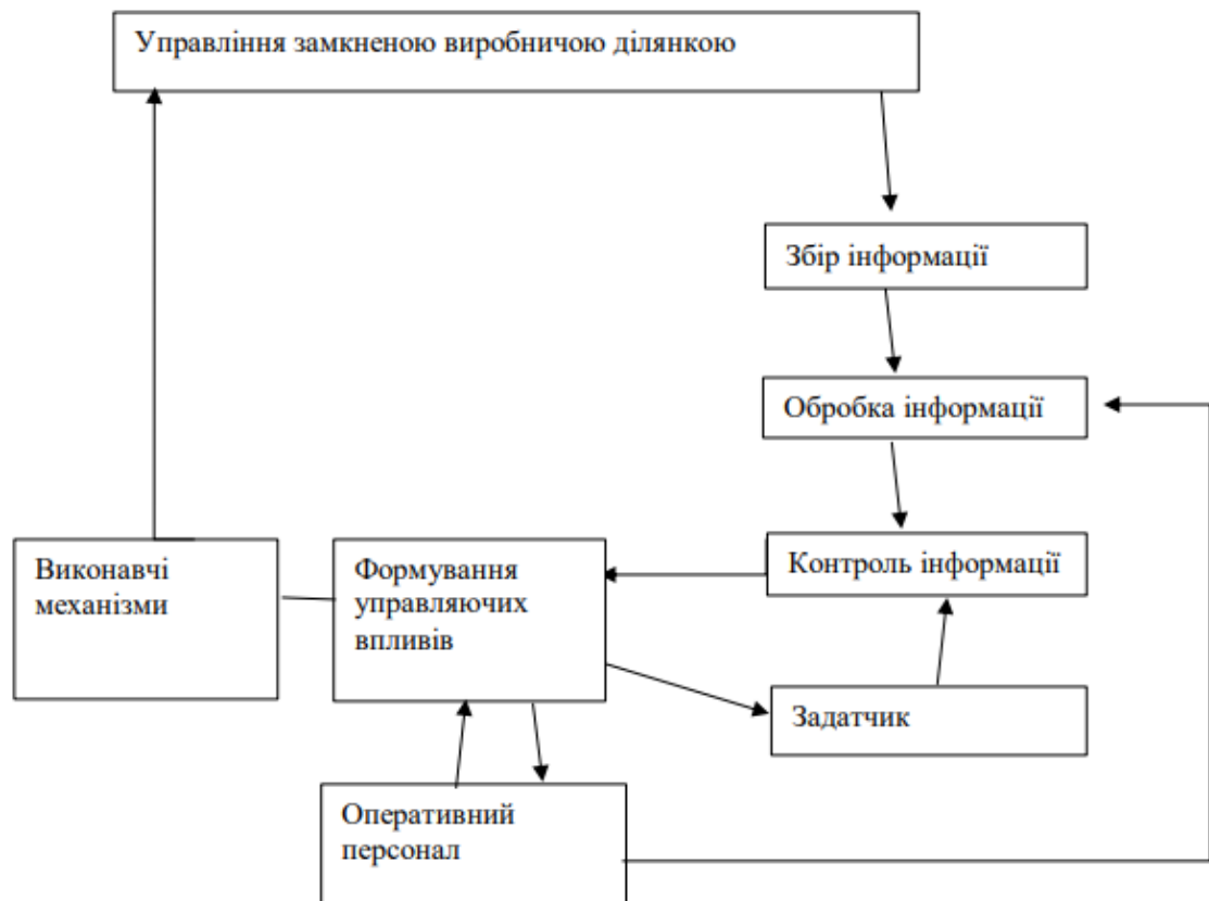
Рисунок 1.3– Узагальнена функціональна структура автоматизованого управління замкненою виробничою ділянкою
