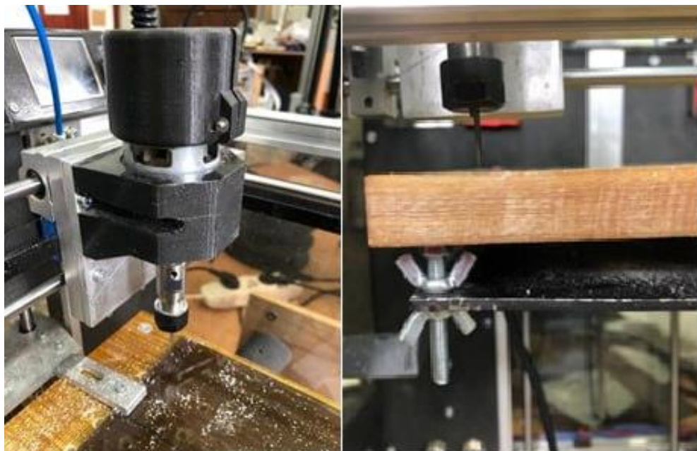
Рисунок 3.6 – Обробка експериментального зразка акрилу на фрезерному верстаті з ЧПК
