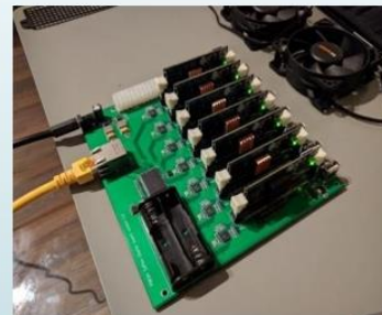
Рисунок 3 – SOPINE Clusterboard плата з 7 модулями SOPINE A64
