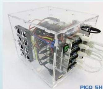
Рисунок 2 – Pico Cluster на основі плати Raspberry Pi 4
