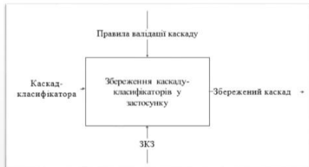
Рисунок 6 – IDEF0-діаграма завантаження навченого каскаду-класифікаторів у застосунок
