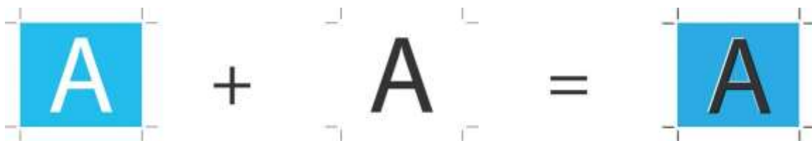
Рисунок 5.1 – Приклад несуміщення кольорів плашки з вивороткою
