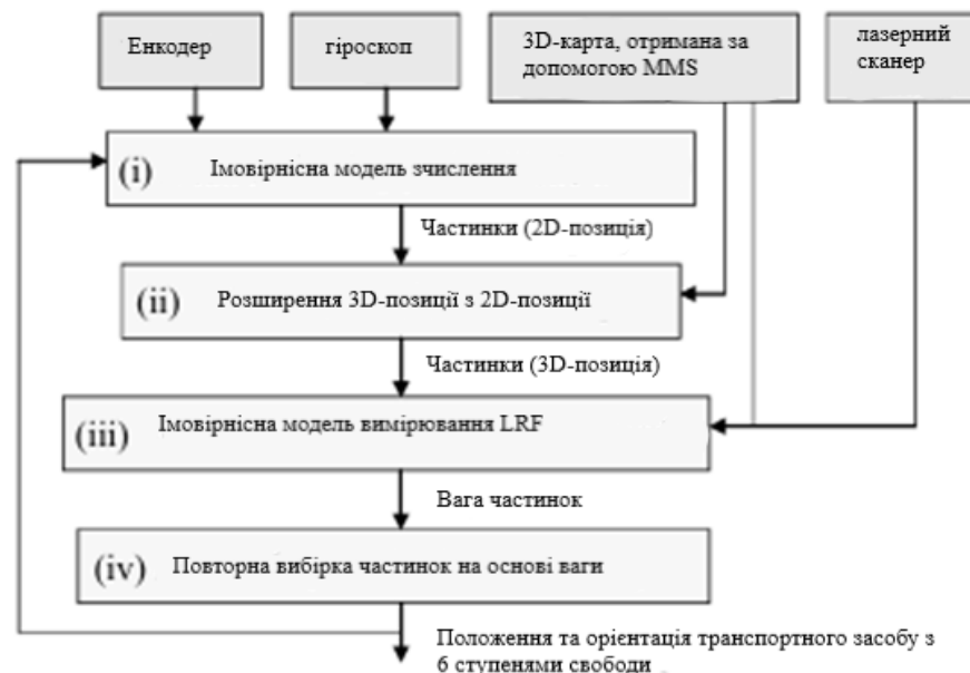
Рисунок 2.6 – Блок-схема локалізації з використанням 3D хмар точок
