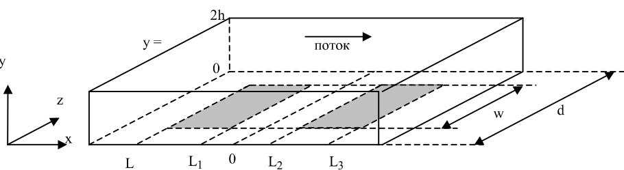
Рис. 1. Схема координат для канала с направленным потоком раствора и двумя микрополосками-электродами
