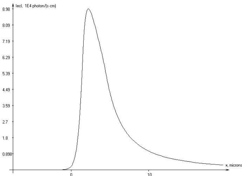
Рис. 3. Распределение интенсивности ЭХЛ вдоль оси  $x$  для параметров из табл. 1 и  $x_{el} = x_{gap} = x_{e2} = 3 \text{ мкм}$ ;  $v_f = 0,01 \text{ см}^3/\text{с}$ ;  $T = 0,008 \text{ с}$
