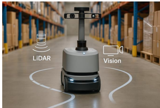
Рисунок 2.7 - Об'єднання LIDAR та камери
