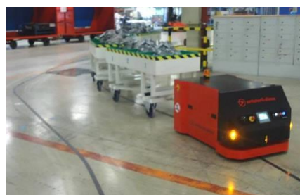
Рисунок 2.2 - Переміщення по електричному провіднику
