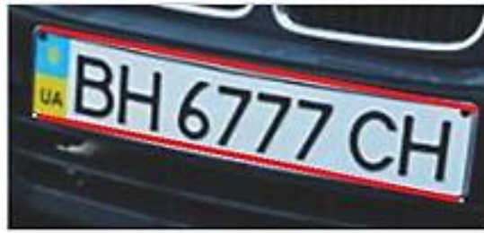
Рисунок 3.6 – Локалізація номерної пластини автомобіля класифікатором Хаара
