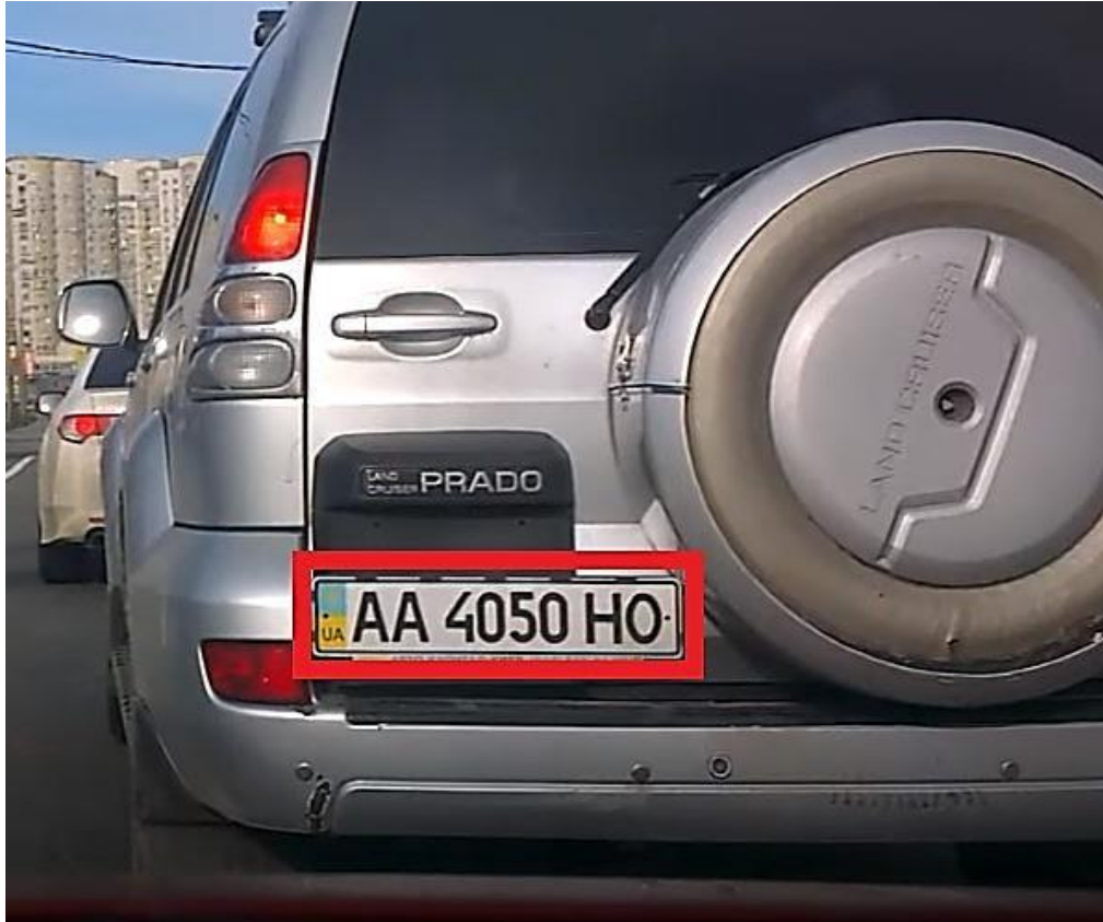
Рисунок 3.13 – Знаходження номерної пластини автомобіля на зображенні
