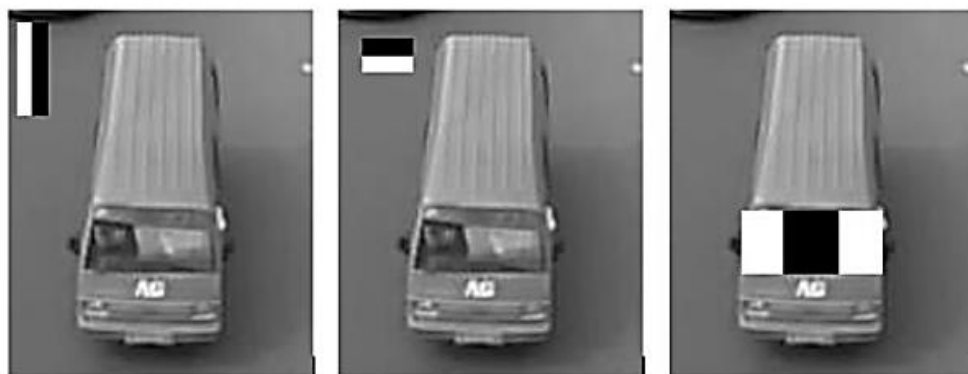
Рисунок 3.2 – Схема розпізнавання контурів зображення за примітивами Хаара
