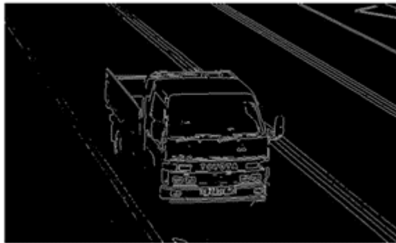
Рисунок 2.6 – Результат детектування контурів оператором Собеля
