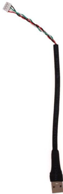
Рисунок 2.14 – Зовнішній вигляд дрота для підключення камери
