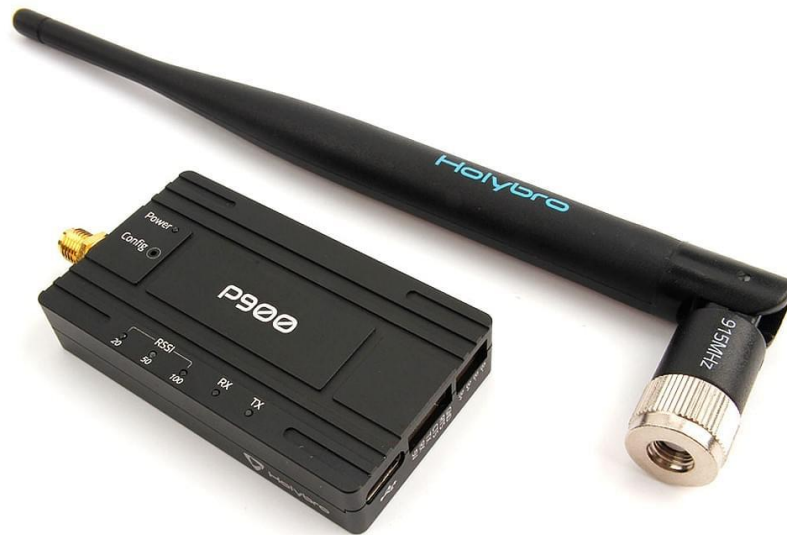
Рисунок 2.18 – Holybro Microhard P900 Radio
