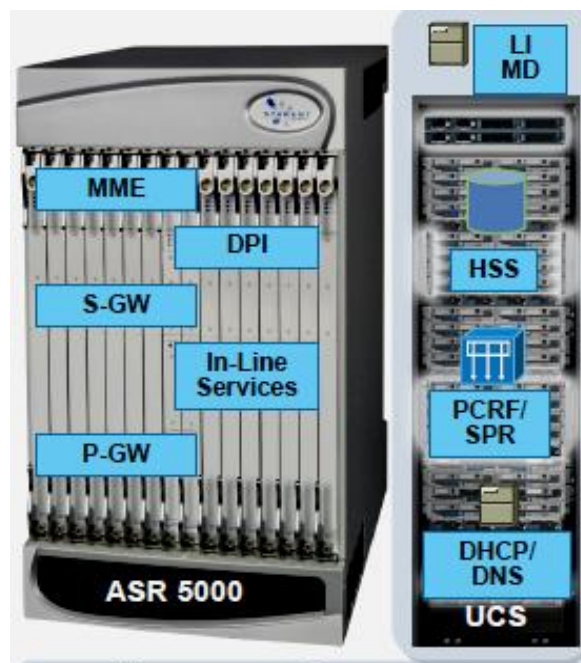
Рисунок 4.1 - Рішення компанії "Cisco Systems" щодо об'єднання функцій мережі EPC на базі однієї платформи "Cisco ASR 5000 PCS3"
