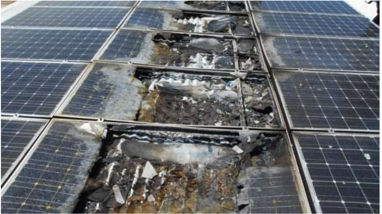
Рисунок 2.1 – Вихід з ладу неякісних сонячних батарей
