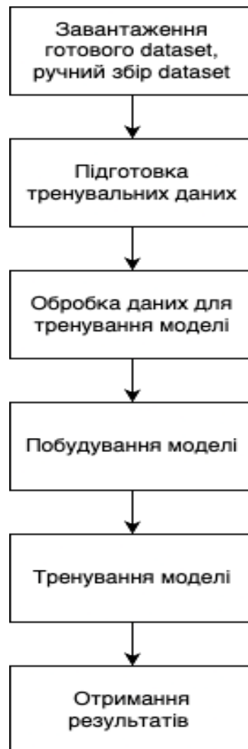
Рисунок 4.2 – Workflow створення моделі розпізнавання звуків
