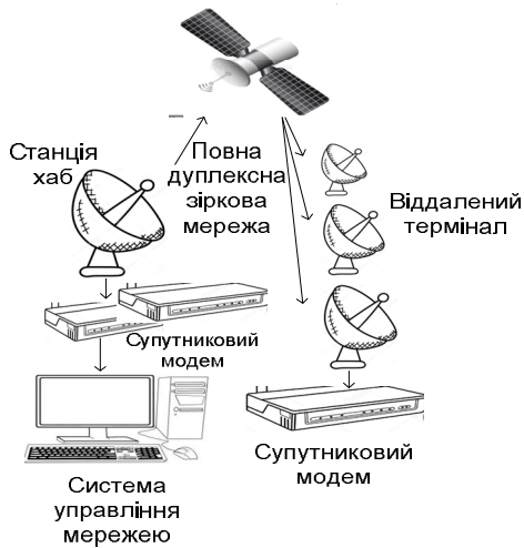
Рис.3. Приклад SCADA-технології з використанням послуг супутникових телекомунікаційних провайдерів
