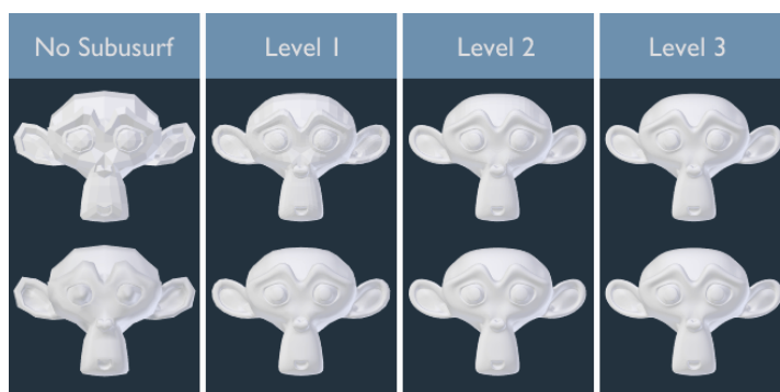
Рисунок 2.3 – Приклад згладження об’єкта Subdivision Surface
