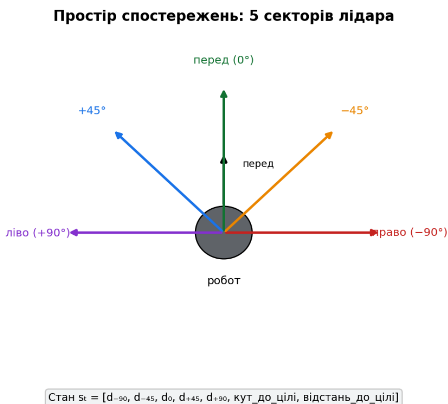
Рисунок 2.3 – Структура простору спостережень: п'ять секторів лідара та вектор на ціль
