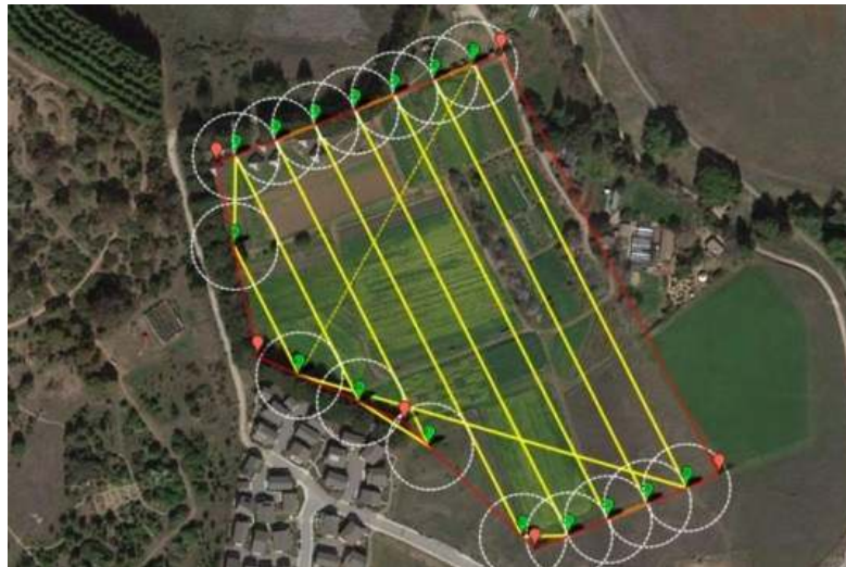
Рисунок 1.9 – Приклад планування польоту drones для обстеження сільськогосподарського поля
