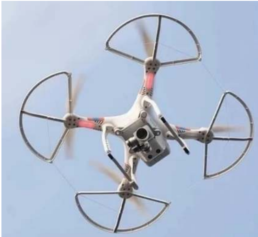
Рисунок 1.1 – Приклад платформи drone на багатороторній технології під назвою квадрокоптер
