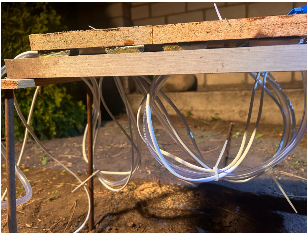
Рисунок 2.2 – Саморобна система Festoon реалізована у макеті
