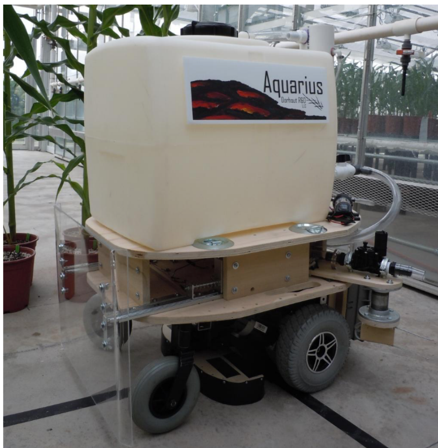
Рисунок 1.1 – Приклад сільськогосподарського робота для автоматизації процесів у теплицях [8]
