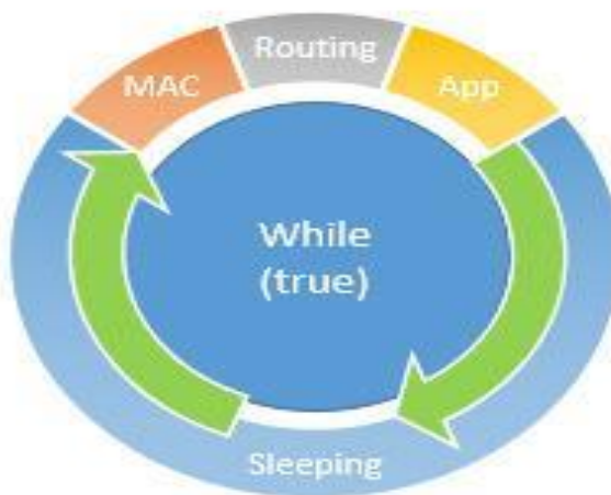
Рисунок 2.6 – Робочий цикл сенсорного вузла
