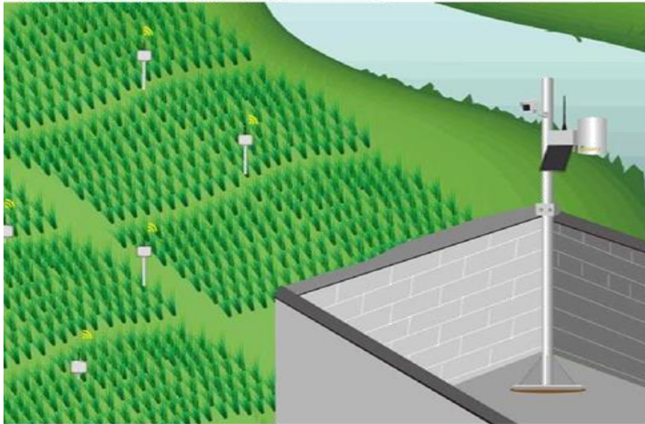
Рисунок 6.3 – Приклад розміщення базової станції у захищеному місці
