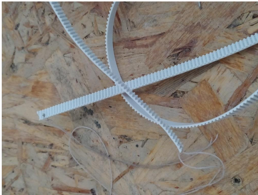
Рисунок 3.2 – Зубчастий ремінь «GT2» шириною 6 мм, що армований сталевим кордом
