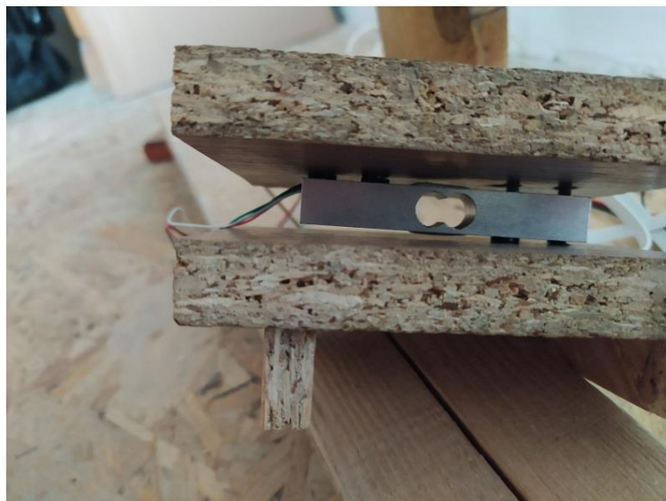
Рисунок 3.1 – Загальний вигляд платформи із вмонтованим тензодатчиком
