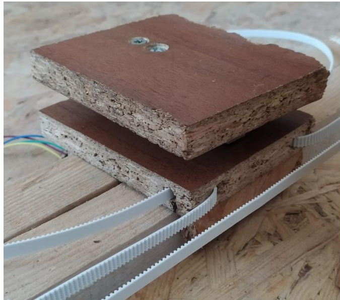
Рисунок 3.6 – Платформа і ремінь, що поєднані між собою
