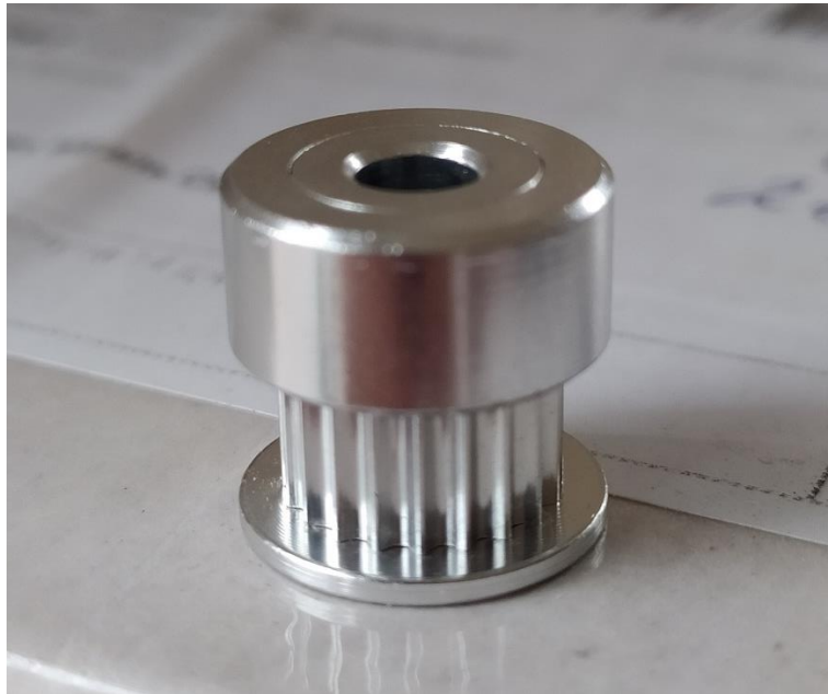
Рисунок 3.3 – Шків «GT2» із внутрішнім діаметром у 5 мм
