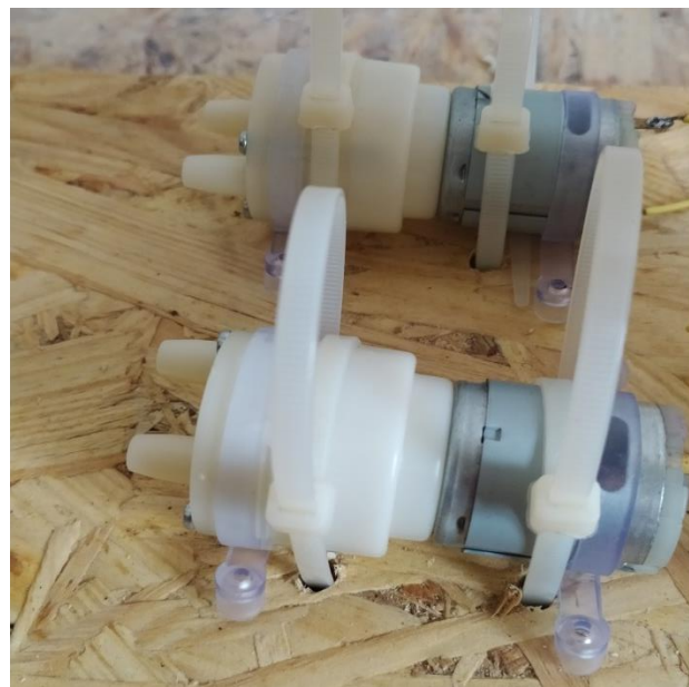
Рисунок 3.8 – Результат монтування насосів
