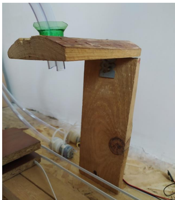
Рисунок 3.7 – Стійка для подачі рідини
