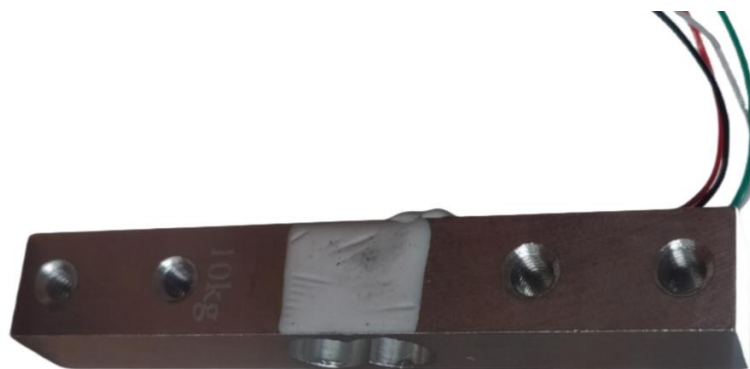
Рисунок 2.10 – Зовнішній вигляд тензометричного датчика
