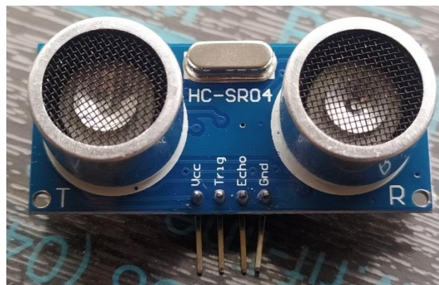
Рисунок 2.9 – Зовнішній вигляд ультразвукового датчика відстані HC-SR04
