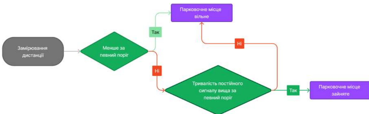
Рисунок 2.9 – Алгоритм маркування даних магнітометра на основі даних ультразвукового сенсору
