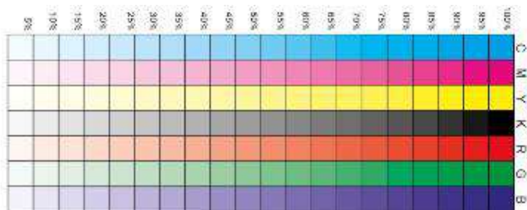
Рисунок 3.5 – Тест-об'єкт для визначення показника «Градаційна передача»
