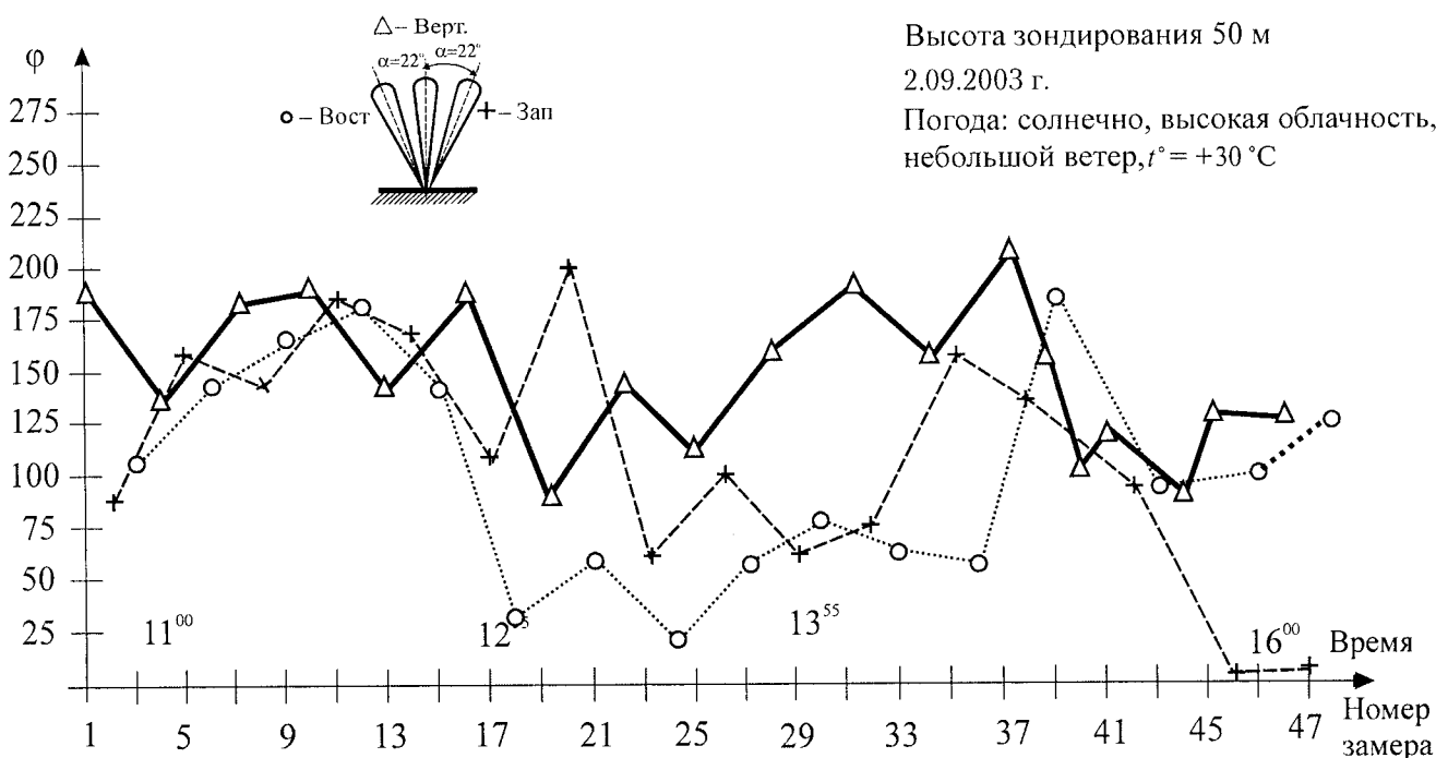
Рис. 5. Зависимость фазы акустического эхо-сигнала от времени для трех углов зондирования: \Delta – для вертикального направления, + – для западного направления при угле \alpha = 22^\circ , O – для восточного направления при угле \alpha = 22^\circ (результаты представлены с учетом влияния эффекта Доплера)
