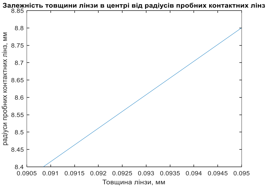
Рисунок 2.5 – Залежність товщини лінзи від радіусу пробних контактних лінз, оптична сила лінзи +5 дптр
