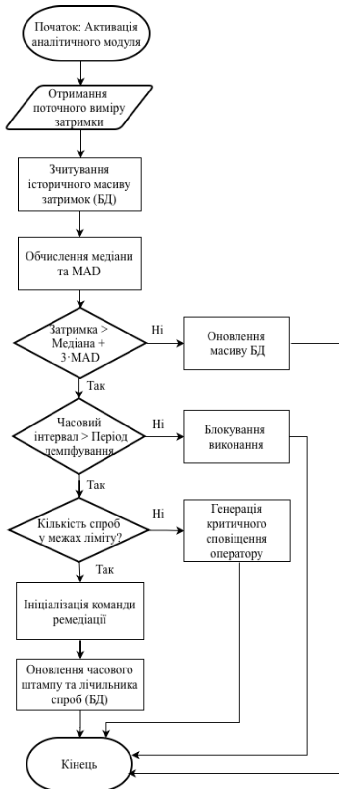
Рисунок 3.2 — Блок-схема алгоритму прийняття рішень аналітичним ядром контуру самовідновлення
