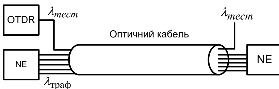
Рисунок 4.3 – Метод моніторингу оптичного кабелю по резервному ОВ
