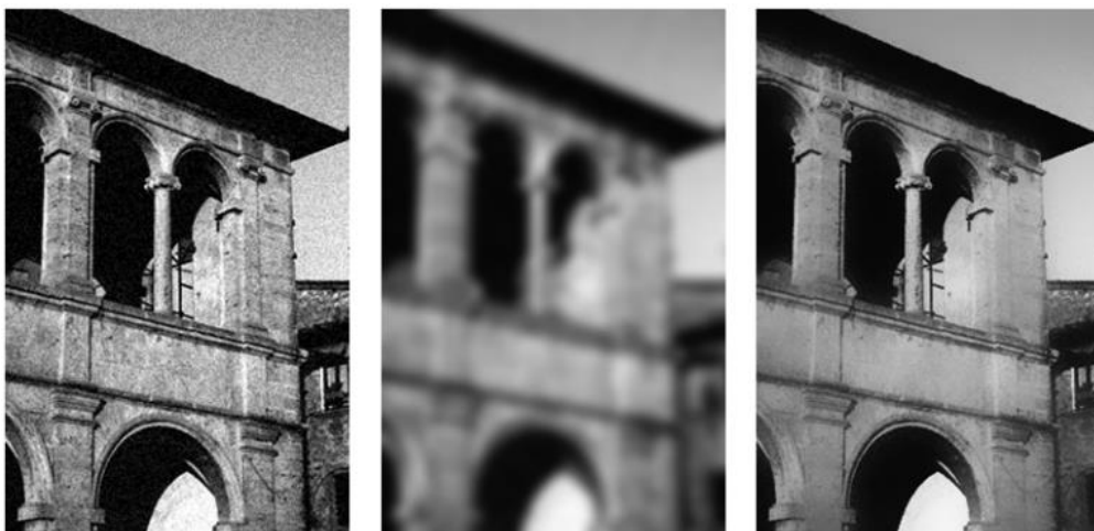
Рисунок 1.9 – Порівняння шумоподавлення усереднюючим і медіанним фільтрами (а – зашумлене зображення, б – шумоподавлення усереднюючим фільтром, в – шумоподавлення медіанним фільтром)
