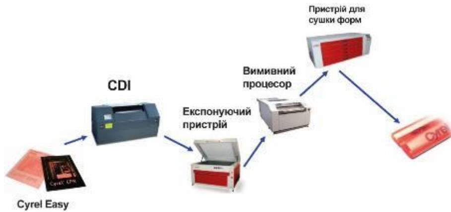
Рисунок 3 – Схема виготовлення флексографічних форм
