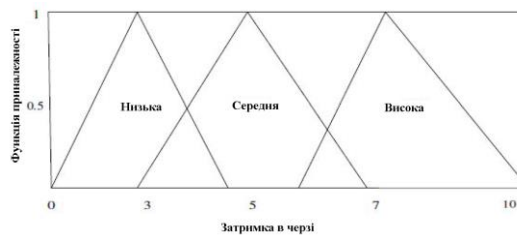
Рисунок 4.5 – Функція приналежності для затримки в черзі
