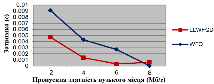
Рисунок 5.5 – Залежність затримки передачі від пропускної здатності вузького місця
