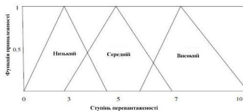
Рисунок 4.6 – Функція приналежності для ступеня перевантаженості
