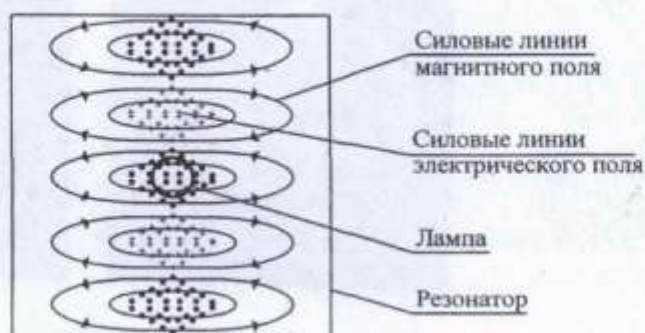
Рис. 1 Структура поля в резонаторе
