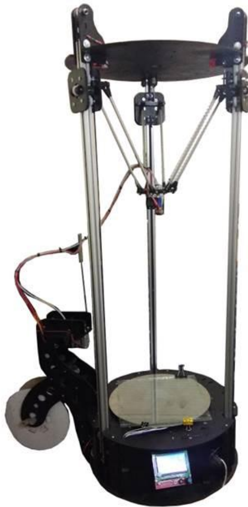
Рисунок 2.1 – Загальний вигляд принтеру з кінематикою «Delta»
