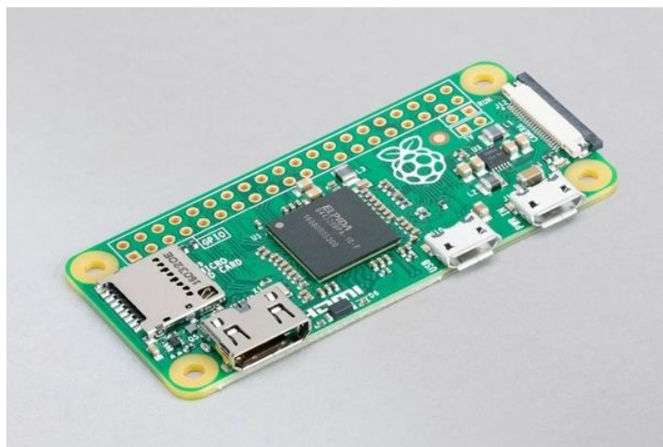
Рисунок 2.2 – Зовнішній вигляд Raspberry Pi Zero
