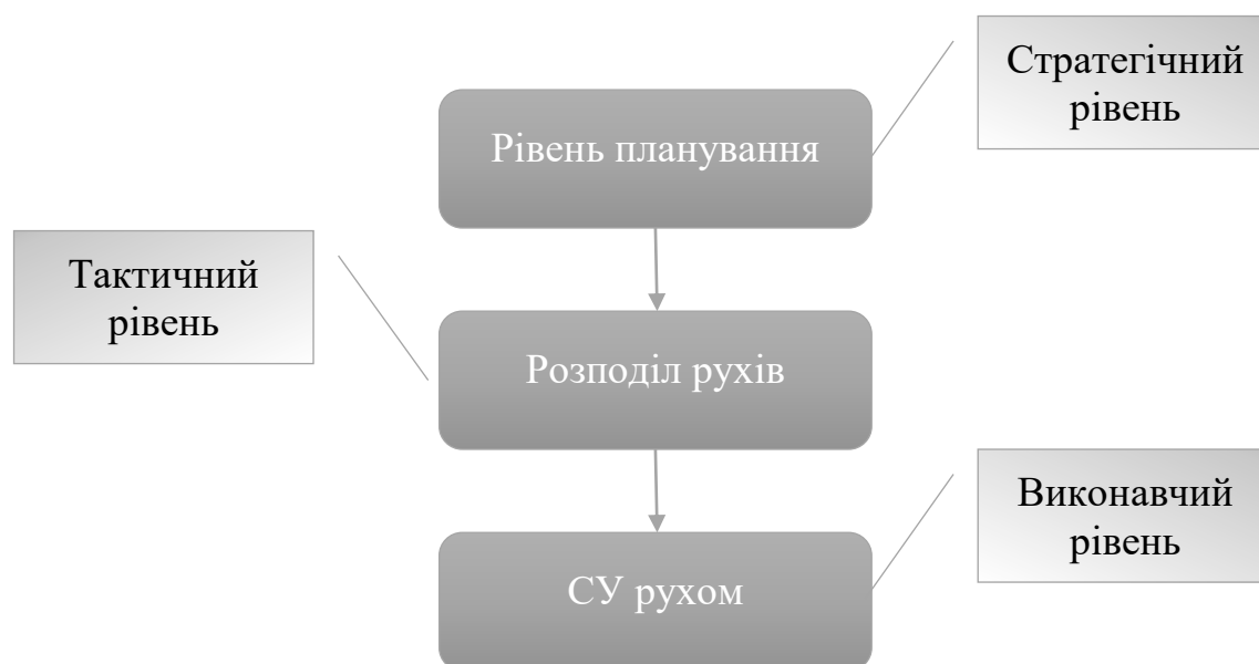
Рисунок 4.1 – Рівні керування роботом
