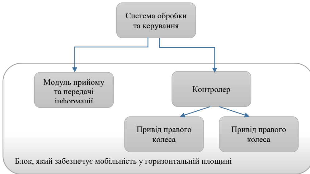
Рисунок 2.1 – Структурна схема блоку, який забезпечує мобільність оптоелектронного скануючого пристрою
