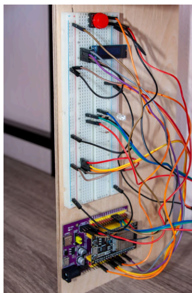
Рисунок 4.4 – Мікроконтролер ESP32 із підключеними периферійними пристроями
