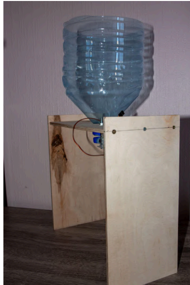
Рисунок 4.7 – Зібраний каркас пристрою дозування разом із вихідною ємністю
