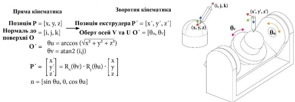
Рисунок 3.18 – Перетворення прямої кінематики в зворотню кінематику для 5-осьового FDM 3D-друку
