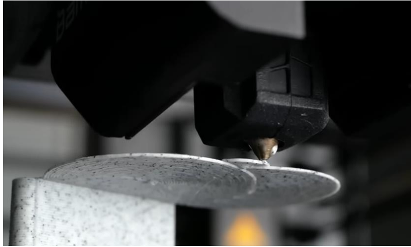
Рисунок 2.10 – Друк нависаючих конструкцій без підтримок
