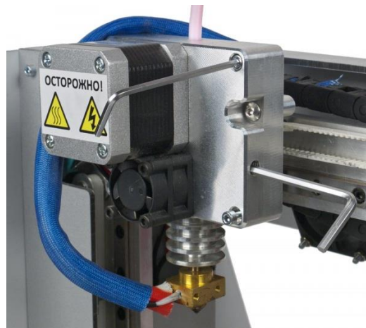
Рисунок 1.22 – Екструдер із прямою подачею
