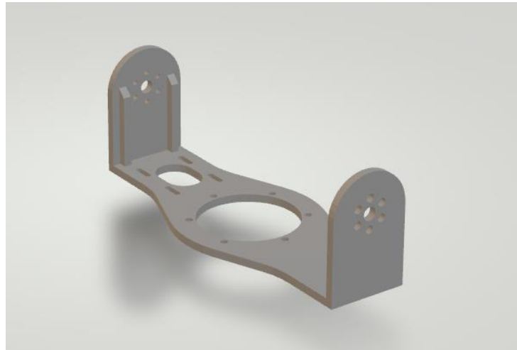
Рисунок 3.9 – Каретка осі обертання U з елементами для кріплення осі обертання V
