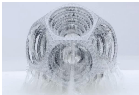
Рисунок 2.13 – Процес використання водорозчинного філаменту PVA
