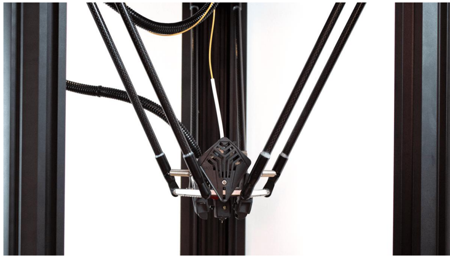
Рисунок 1.11 – Друкуюча голова 3D-принтера типу Delta з кронштейнами
