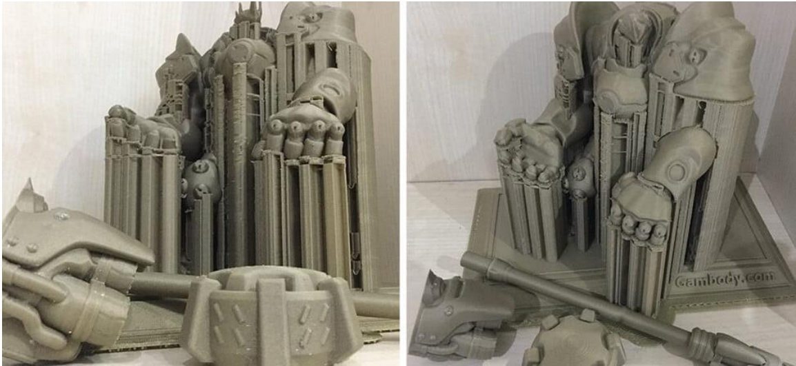
Рисунок 2.3 – Використання лінійних підтримок в 3D-друці
