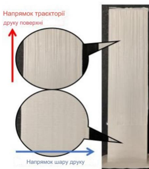
Рисунок 4.3 – Напрямок траєкторії поверхневого друку перпендикулярний до напрямку друкованого шару
