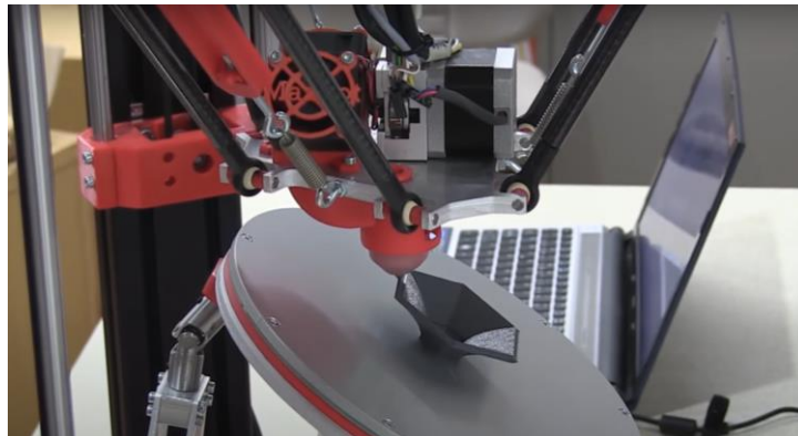
Рисунок 2.8 – Процес друку 6 осевого 3D-принтера без підтримок [22]
