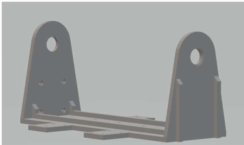
Рисунок 3.1 – Каретка осі Y з елементами для кріплення осі обертання U
