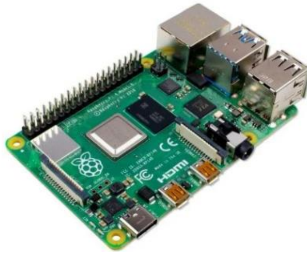
Рисунок 2.3 – Одноплатний комп'ютер Raspberry Pi 4B
