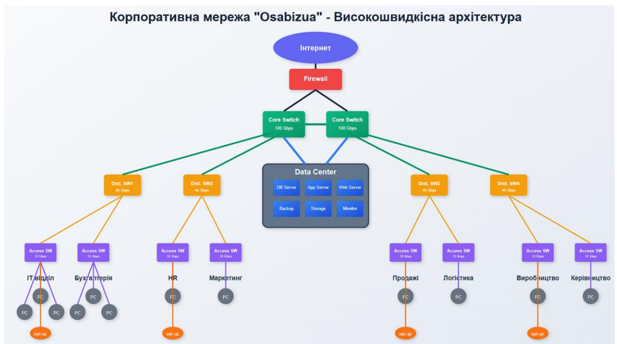
Рисунок 4.1 – схема корпоративної мережі «OsabizUA»
