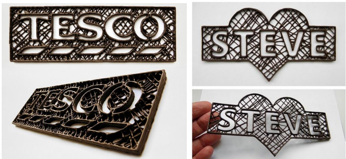
Рисунок 2.2 – Приклади відтворення шоколадних виробів за допомогою 3D-принтера
