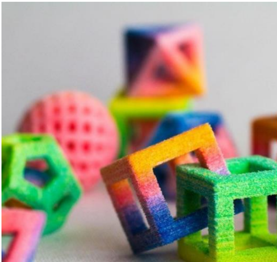
Рисунок 2.6 – Приклад відтворення кольорових цукрових виробів за допомогою 3D-принтера
