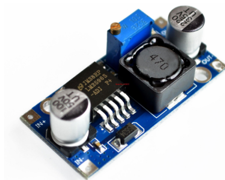
Рисунок 5 – Преобразователь понижающий LM2596, DC-DC
