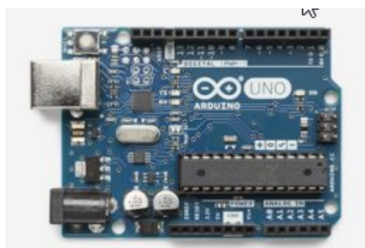
Рисунок 2 - Общий вид Arduino Uno
